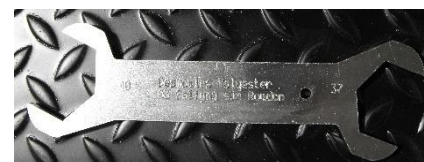
Clef en acier galvanisée serrage des raccords PEHD
